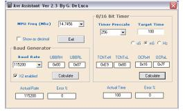
Con questa configurazione otteniamo un periodo di intervento di 100 mSec. Abilitando l'interrupt corrispondente e indicando l'indirizzo di gestione, il programma ogni 100 mSec salterà all' Interrupt Handler ed eseguirà le istruzioni contenute nella subroutine.
